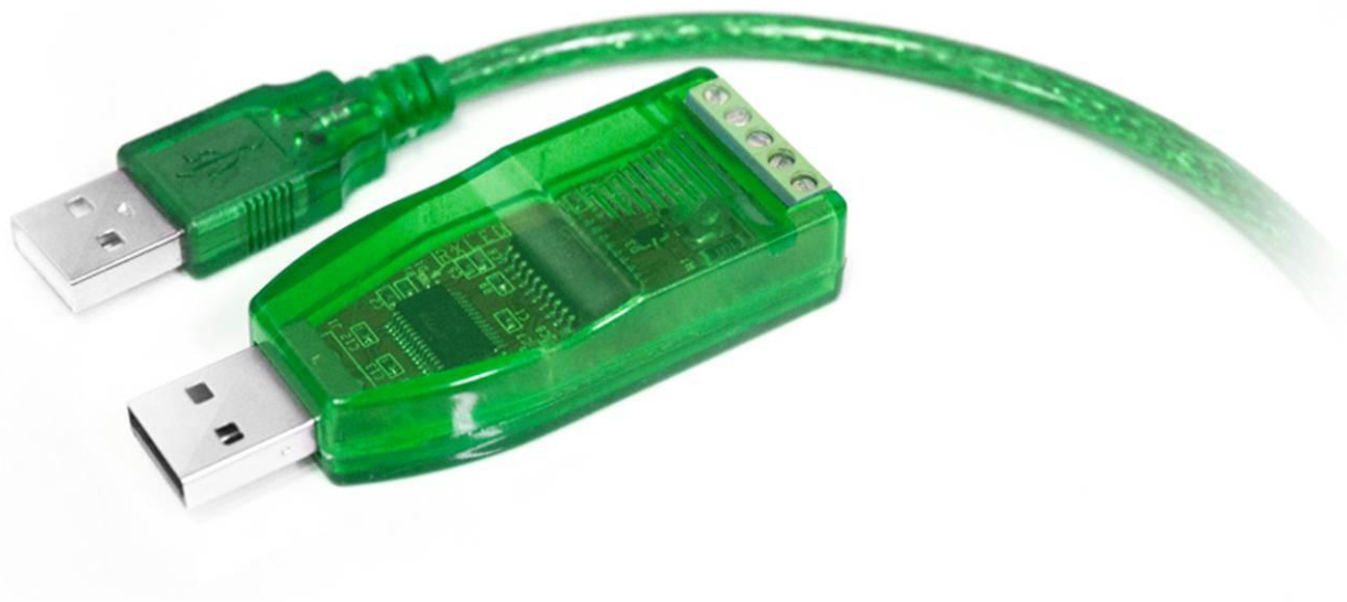
Рисунок 1.1. Внешний вид преобразователя интерфейсов Юкка.
