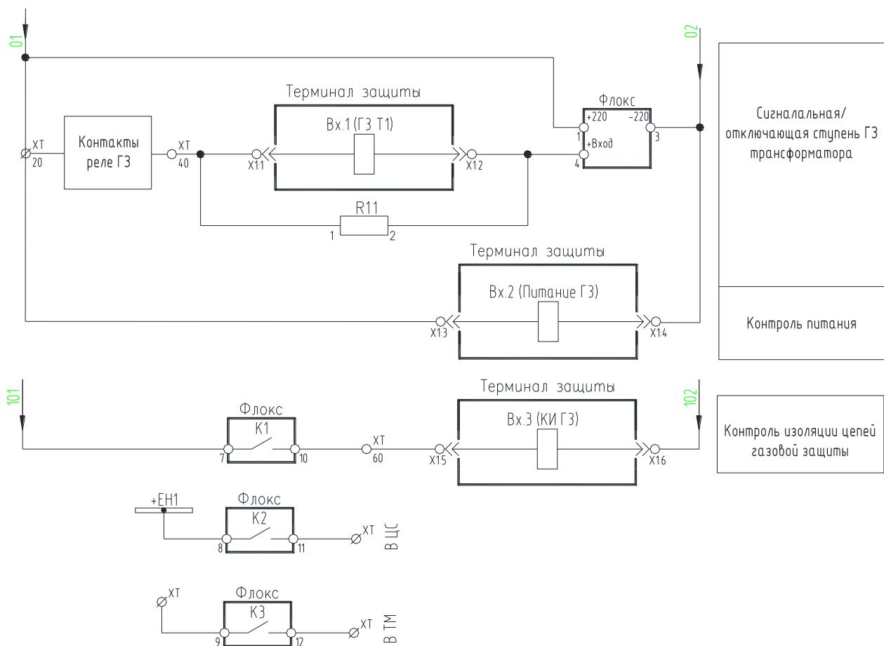
Рисунок 4.2 – Пример вторичной схемы с использованием реле Флокс
