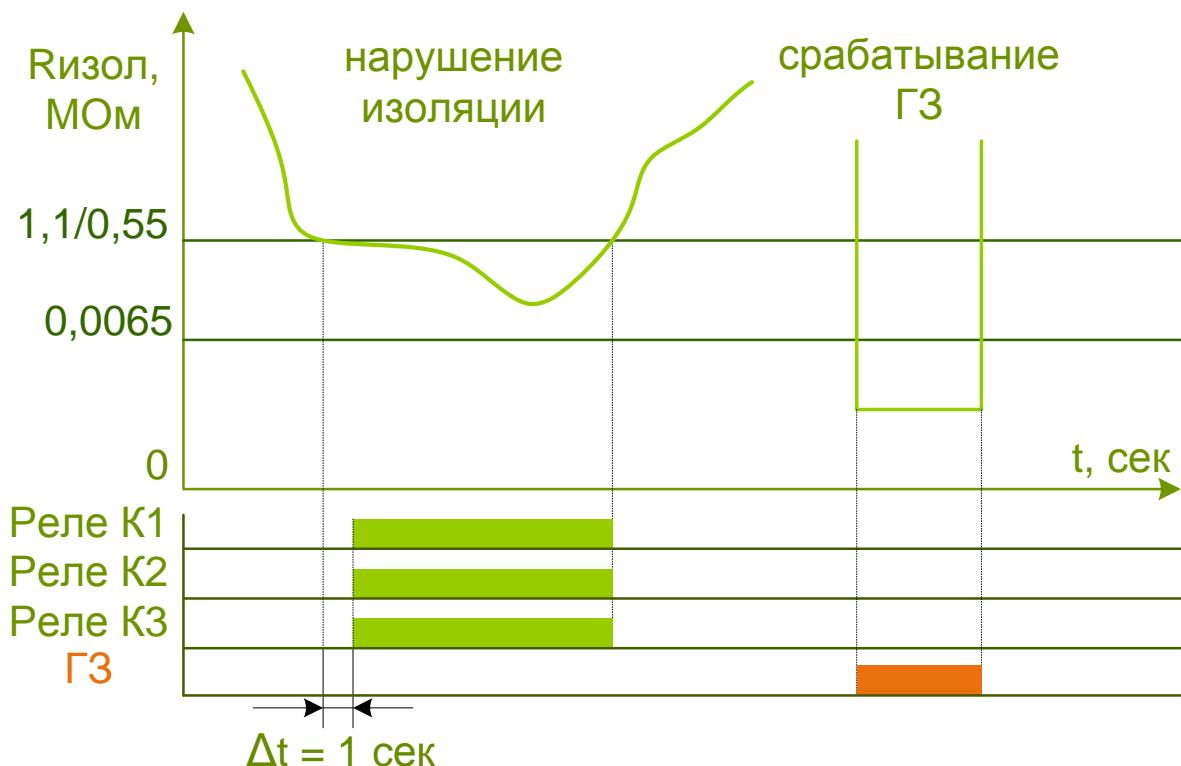
Рисунок 2.1 – Эпюра срабатывания выходных реле Флокс
