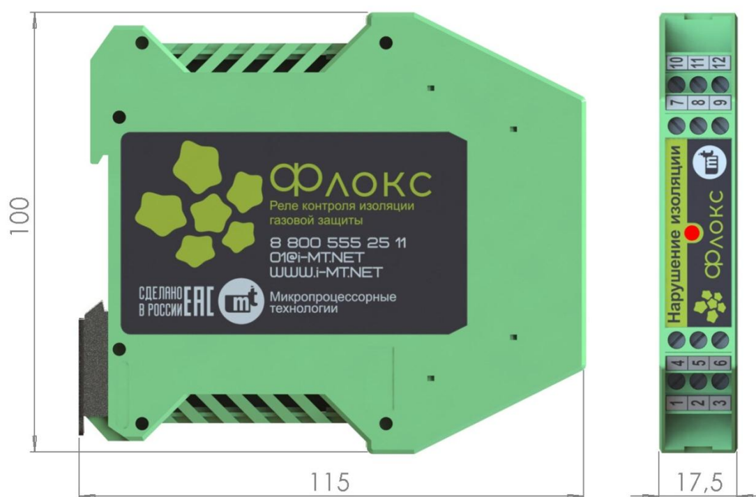
Рисунок 3.1 – Габаритные размеры реле Флокс
