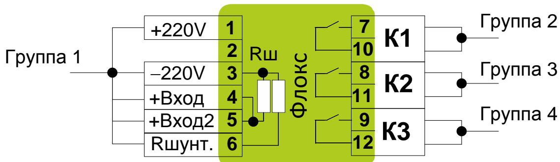
Рисунок 4.3 – Объединение входных и выходных цепей в независимые группы для измерения сопротивления изоляции
