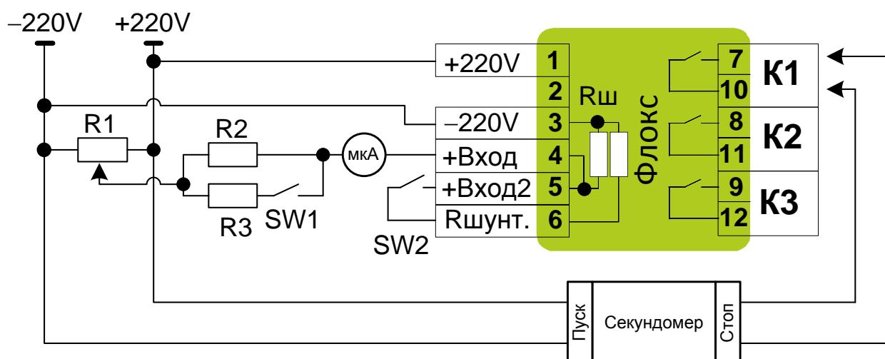
Рисунок 4.4 – Схема подключения для проверки реле Флокс
