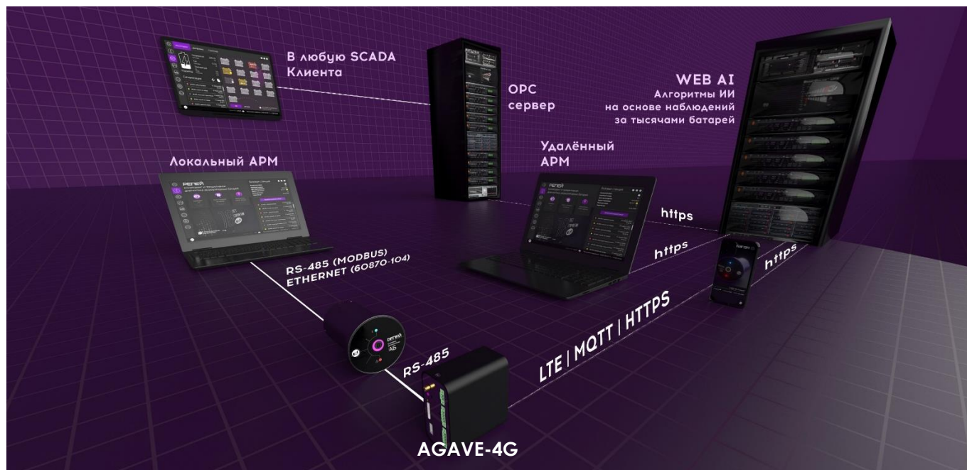
Рисунок 1.1 – структурная схема применения AGAVE-4G
