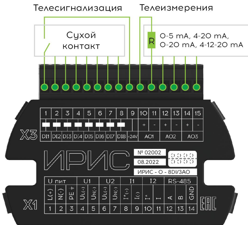
Рисунок 12.9 - Схема подключения рюкзак ИРИС-O-8DI/3AO
