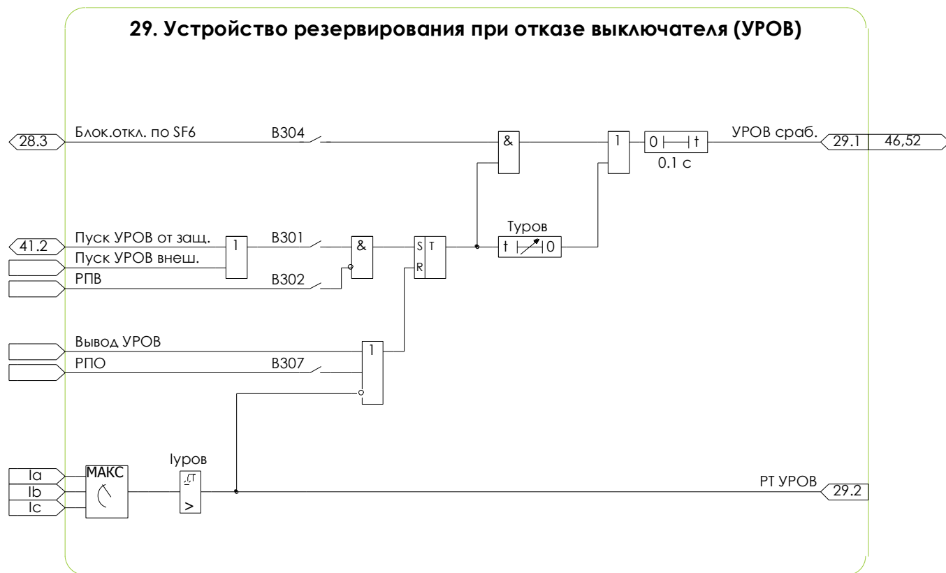
Рисунок 8.2 – Схема №29. Алгоритм УРОВ
