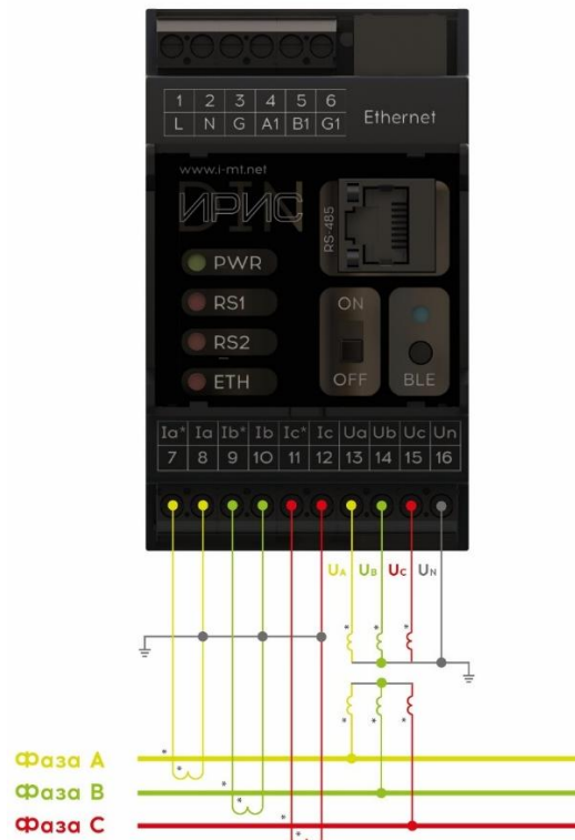
Рисунок 10.2 - Схема подключения устройства с внешними трансформаторами тока и трансформаторами напряжения (ЗТТ, 3ТН) исполнения 2RSTX
