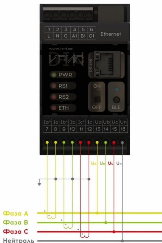
Рисунок 10.1 - Схема подключения устройства с внешними трансформаторами тока, без трансформаторов напряжения (ЗТТ, 0ТН) исполнения 2RSTX
