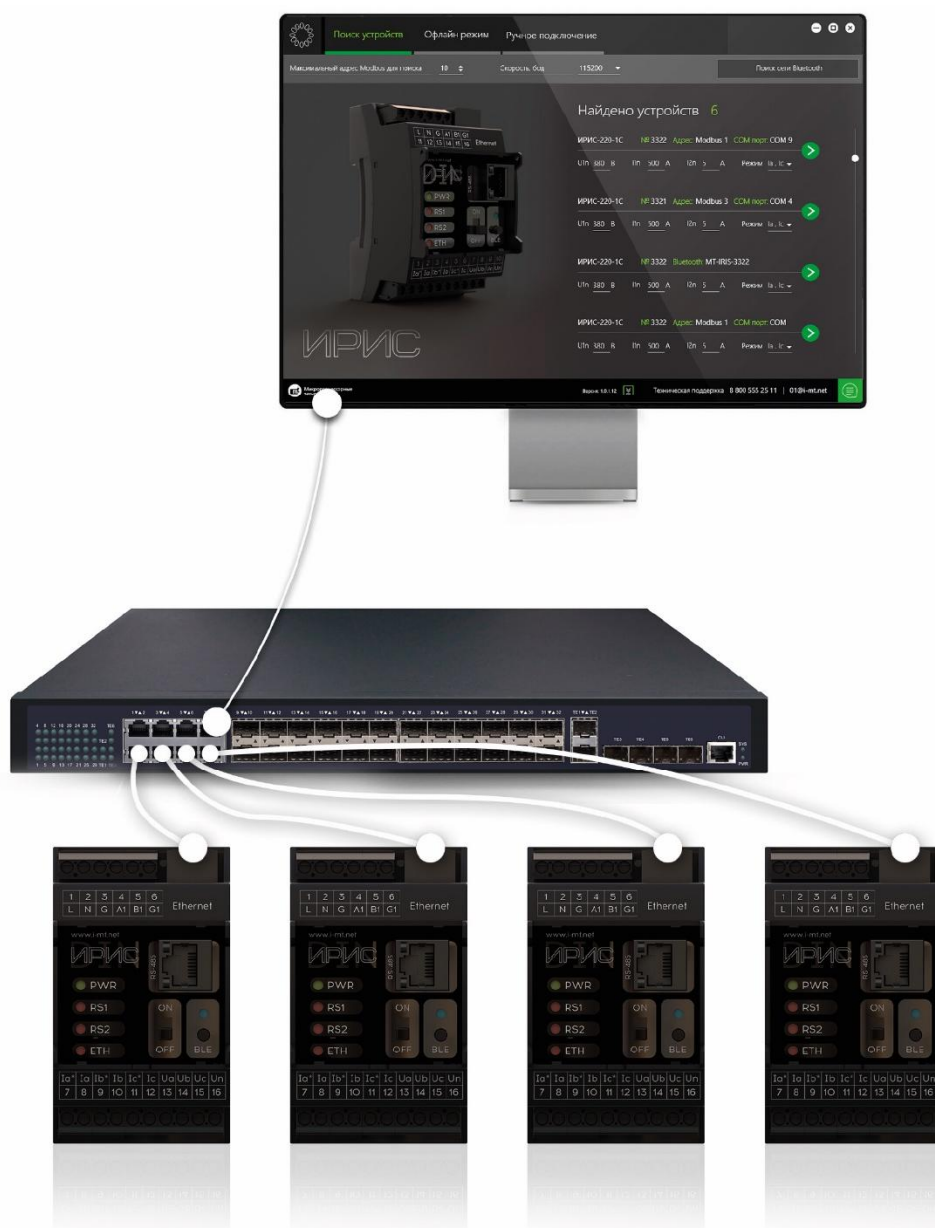
Рисунок 4.4 – Схема организации сети Ethernet
