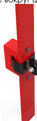
г) Прижать концы ленты друг к другу, обеспечив плотное прилегание к шине/кабелю. Надеть зажим и зафиксировать его, используя винт, шайбу и гровер. Зафиксировать ленту так, чтобы ее концы были заподлицо с зажимом
