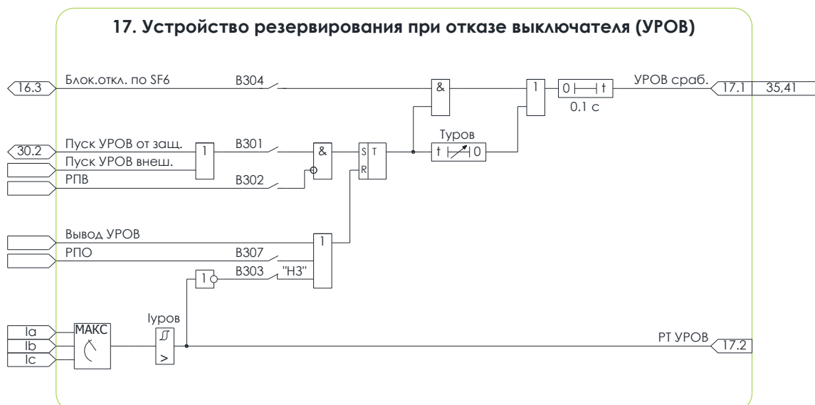
Рисунок 5.17 – Схема №17. Алгоритм УРОВ
